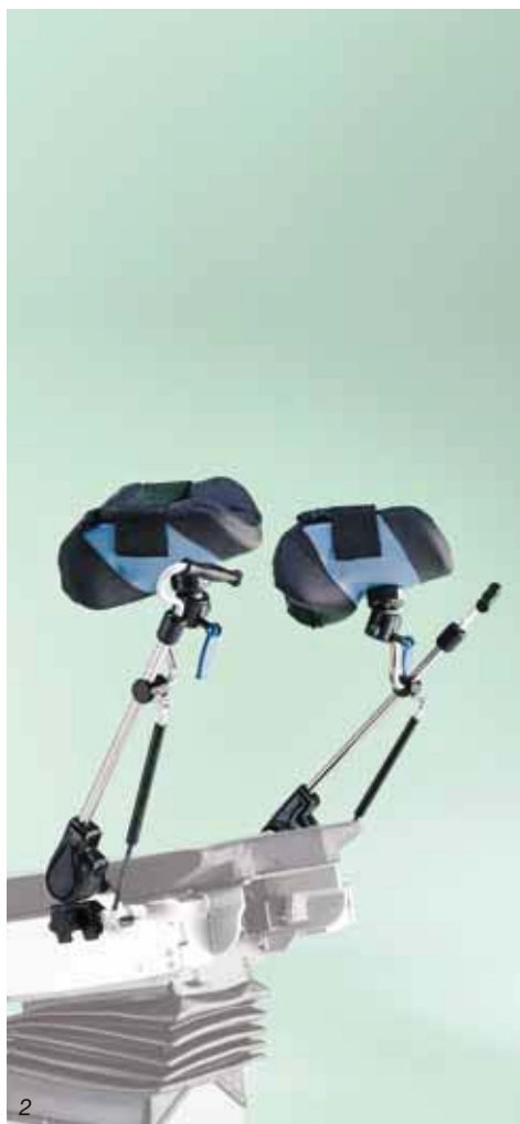
3 Podnózek (typu Göpel) 101.0115.0 zintegrowane poduszki z pianki, czarne, antystatyczne, z pasami na rzepy, bez uchwytów mocujących. Stal nierdzewna 18/10, długość pręta 520 mm. Wymaga klamr mocujących nr 101.0018.0 lub 101.0146.0.
