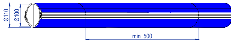
Rys. Łączenie dwudzielnej rury osłonowej typu AØ110PS (1:10)
