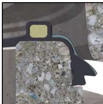
Szkic 1: Uszczelka samosmarująca z kompensatorem naprężeń
