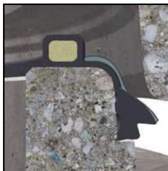
Szkic 1: Uszczelka samosmarująca z kompensatorem naprężeń
