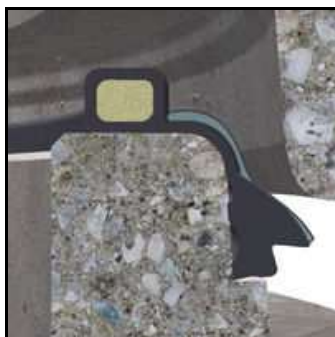
Szkic 1: Uszczelka samosmarująca z kompensatorem naprężeń
