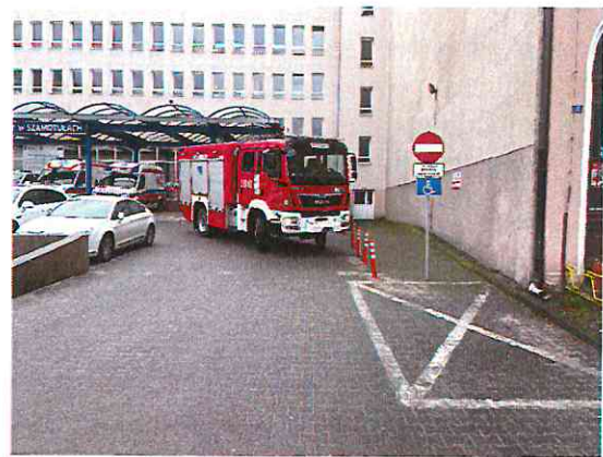
Uwaga: Widoczne słupki oddzielające dojście do klatki schodowej od drogi pożarowej są wykonane z tworzywa.
