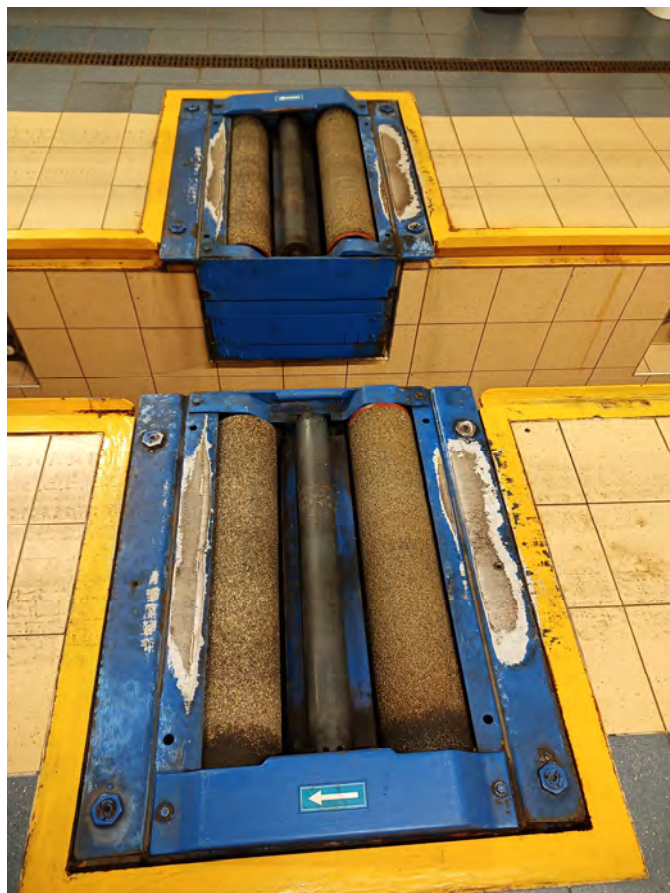
Fot.9 – Szczegół oparcia rolek – korozja toru na styku i obudowy urządzenia
